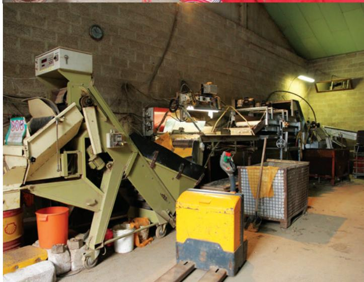
Comme souvent, l'arrachage est quasiment réalisé selon les demandes des clients. Notre homme a adapté une sorte de tapis brise-chute à la sortie de la trémie où passent ses pommes de terre. Il les stocke dans un pallox adapté en fonction de la variété choisie. La ventilation de son hangar, il l'a réalisé lui-même, avec une commande manuelle. Il vérifie régulièrement les températures obtenues pour la conservation de ses pommes de terre.
